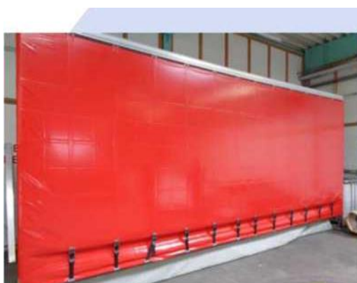
Immagine 1: Telone scorrevole con armatura antivandalo e antifurto
